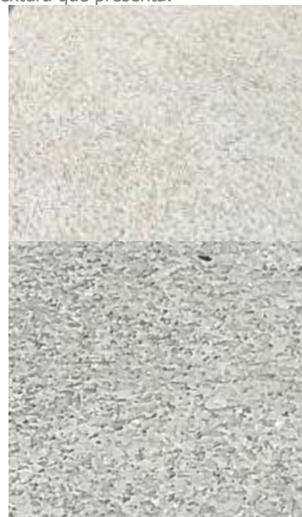
Aspecte del formigó amb acabat rentat a l'àcid, i ampliació de la textura que presenta.
